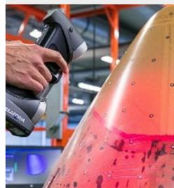
**OBJETIVO:** Fabricar Moldes a alta velocidad y "precisión", desde la Ingeniería Inversa como del diseño digital 3D, eliminando procesos correctivos y evidenciando errores al operar escáner laser 3D. (Incluir SW de generación automática de Moldes / Autodesk Moldflow).
